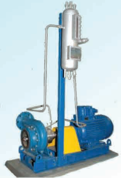
В насосе применены подшипники скольжения, торцовое уплотнение работает на затворной жидкости.
